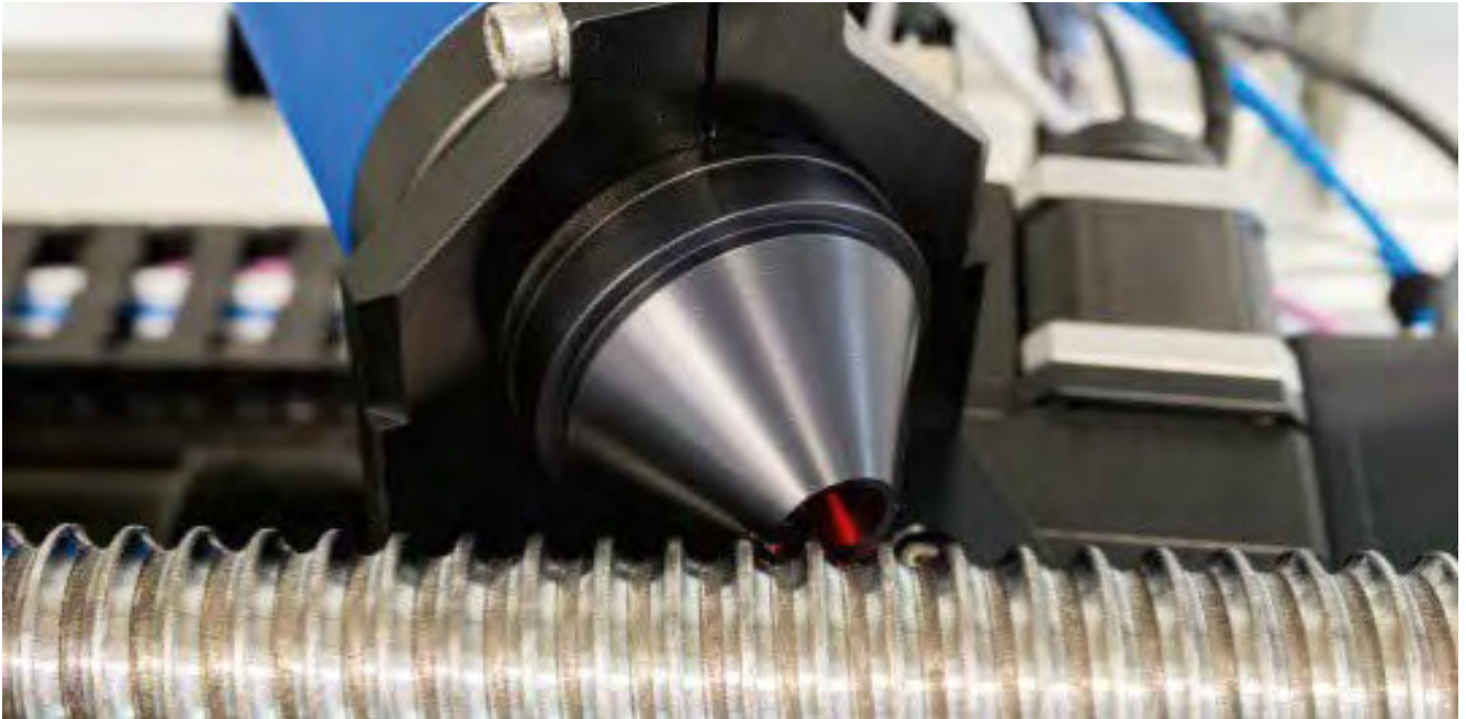
↑ Welligkeitsmessung eines Kugelgewindetriebs
