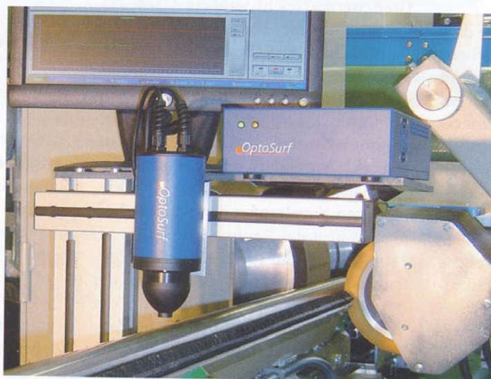
Bild 1. Streulichtmessgerät bei der Inline-Rauheitsmessung in einer Bandschleifmaschine
