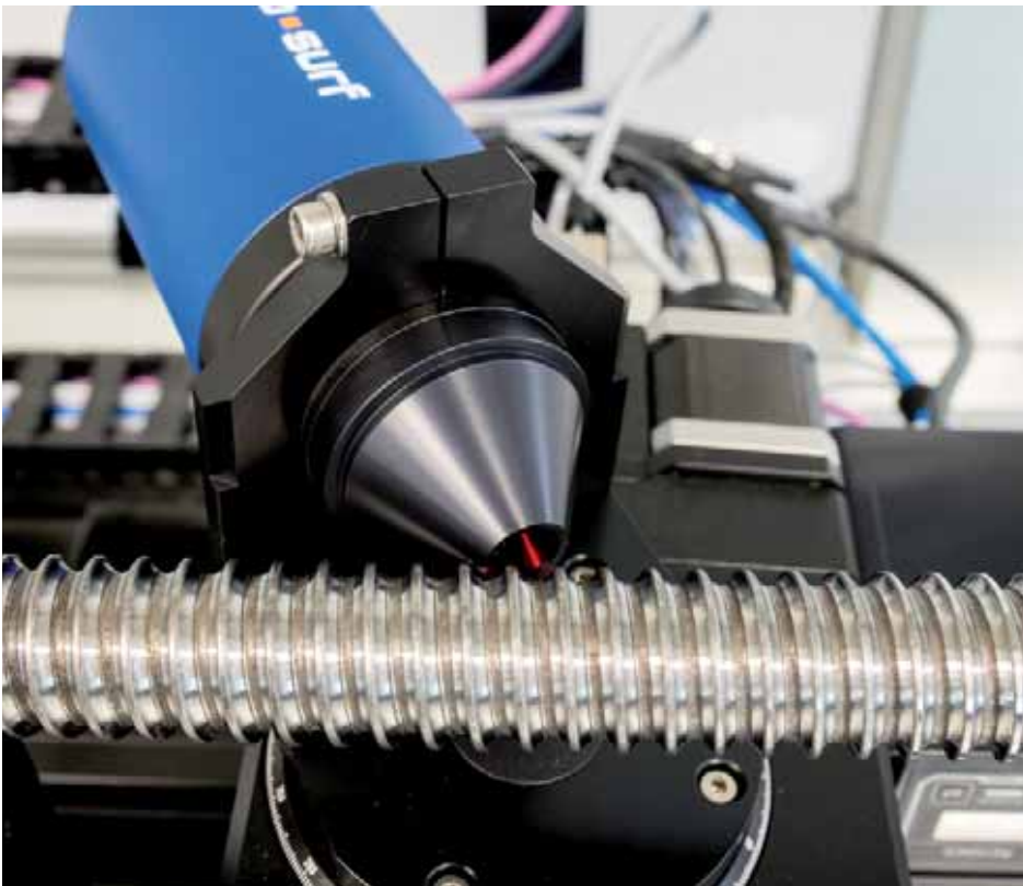
Die Messung der Funktionsfläche auf dem Gotischen Bogen einer Kugelumlaufspindel. Foto: OptoSurf
